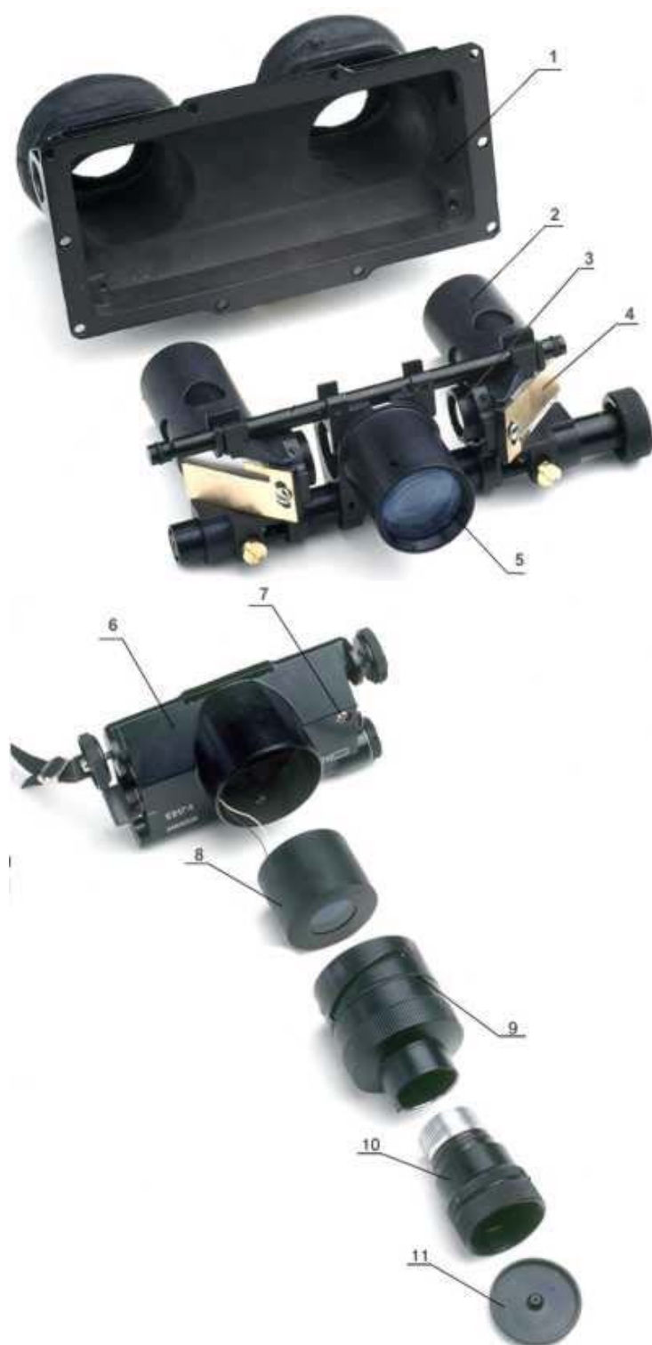
Рис. 24. Устройство ОНВ псевдобинокулярной схемы ПНВ: 1 – корпус ОНВ; 2 – окуляр; 3 – оборачивающий объектив; 4 – зеркало; 5 – коллиматор (лупа) с призмой; 6 – корпус ОНВ; 7 – ИК-подсветка; 8 – ЭОП; 9 – корпус объектива; 10 – объектив; 11 – крышка объектива
